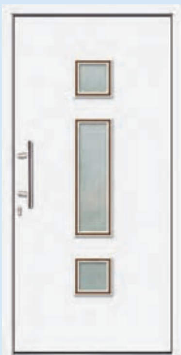
Kunststoff Modell 2076-2 (PG40) Aluminium Modell 4076-2 (PG42) Variante: Kontur, mit äußerem Vollblatt-Design Außen Ornamentrahmen mit Applikationen aus Thermo-Buchenholz, innen Ornamentrahmen ohne Applikationen 3fach-Glas: Klar plan, Mattierung „Bonn“ Griff: HA1039-40 Edelstahl PZ-Rosette: HA1075 Edelstahl (oval)
