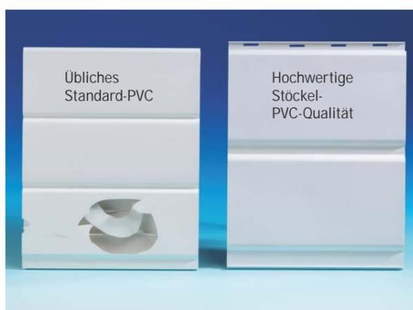
Der Vergleich von einem üblichen PVC zur hochwertigen PVC-Qualität zeigt im Klammer- und Kugelfalltest die enorme Belastbarkeit der Stöckel-Kunststoffprofile.
